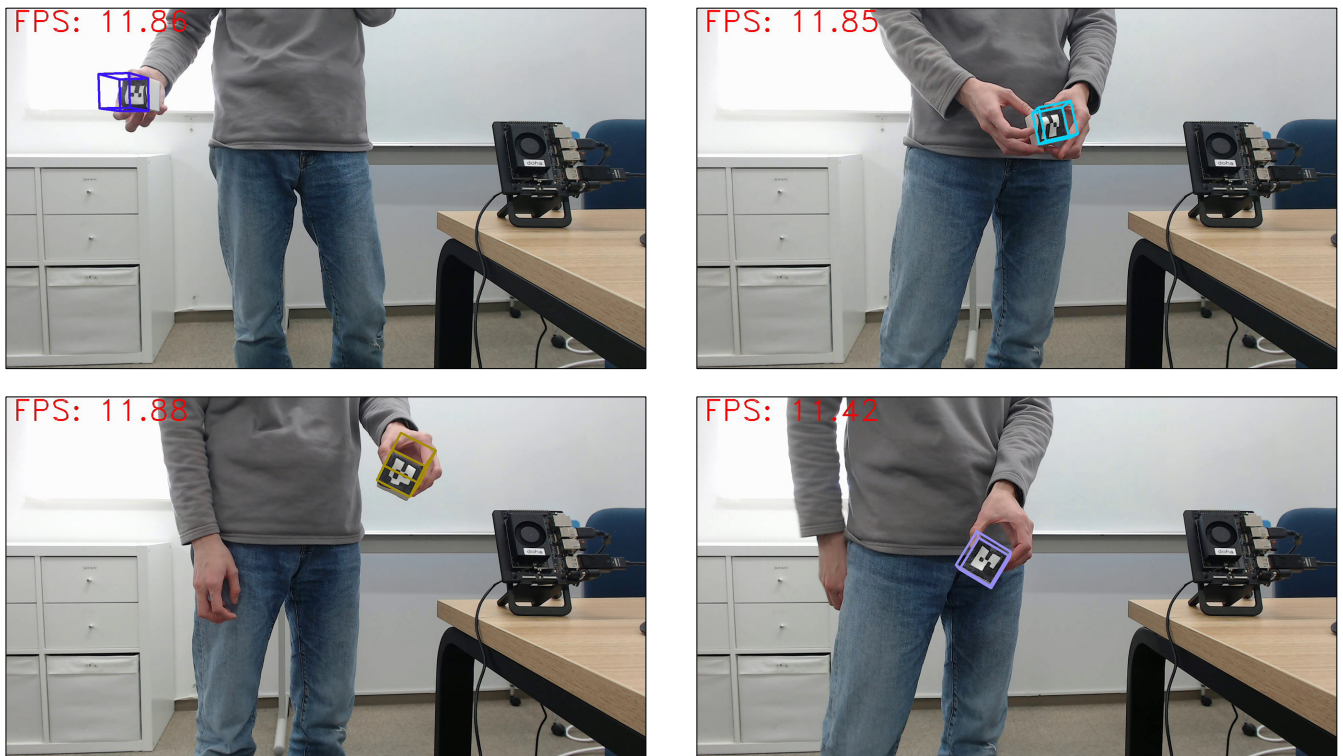
図 12 実環境におけるデモンストレーションの例。変形 AR マーカの ID をワイヤーキューブの色で表し、変形 AR マーカの位置と姿勢をワイヤーキューブの位置と姿勢で表現している
